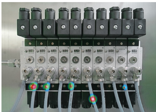
LeakCam 600 z 64 mikrofonami (Power Beam Forming)
